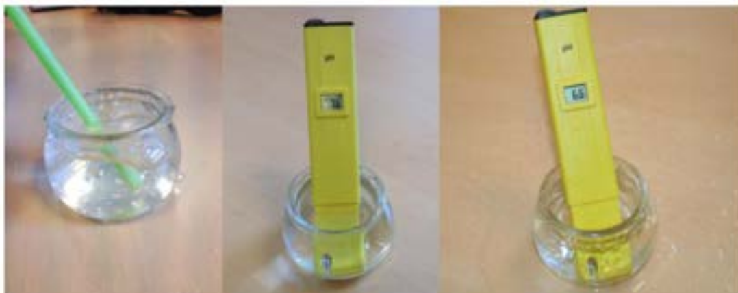
Au début de l'expérience, le pH est 7,6. Après avoir soufflé dans la paille pendant 2-3 minutes, le pH est descendu à 6,6. Classe de CM1 de Sabine Lanoé (Paris)
